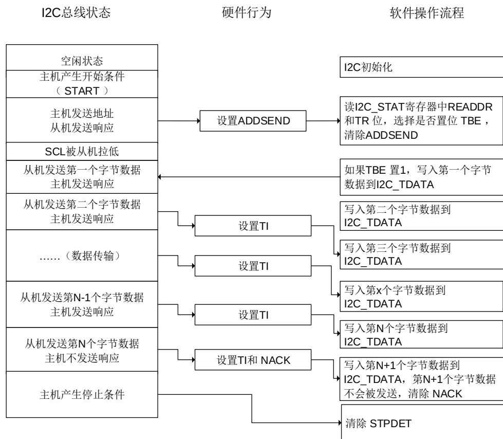
图 26-14. I2C 从机发送编程模型 (SS=0)
