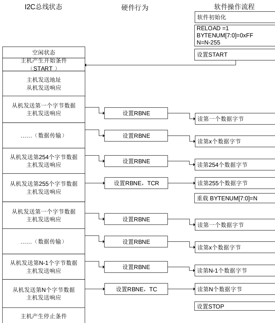
图 25-21. I2C 主机接收编程模型（N>255）
