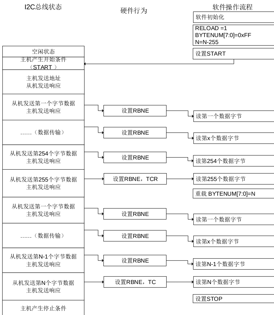
图 26-21. I2C 主机接收编程模型 (N>255)
