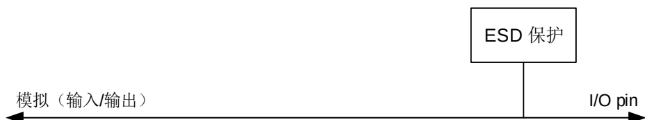
图 6-4. 模拟配置的基本结构
