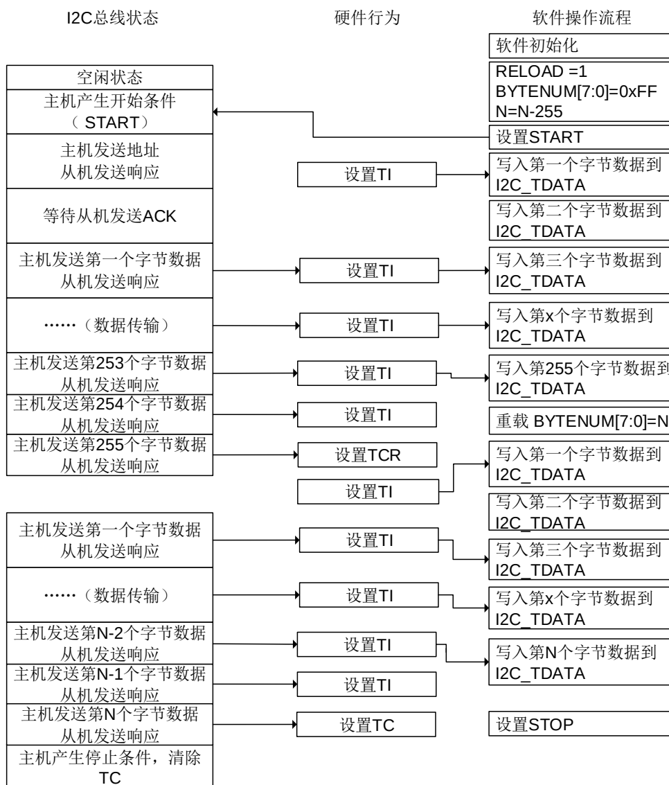
图 16-19. I2C 主机发送编程模型 (N&gt;255)
