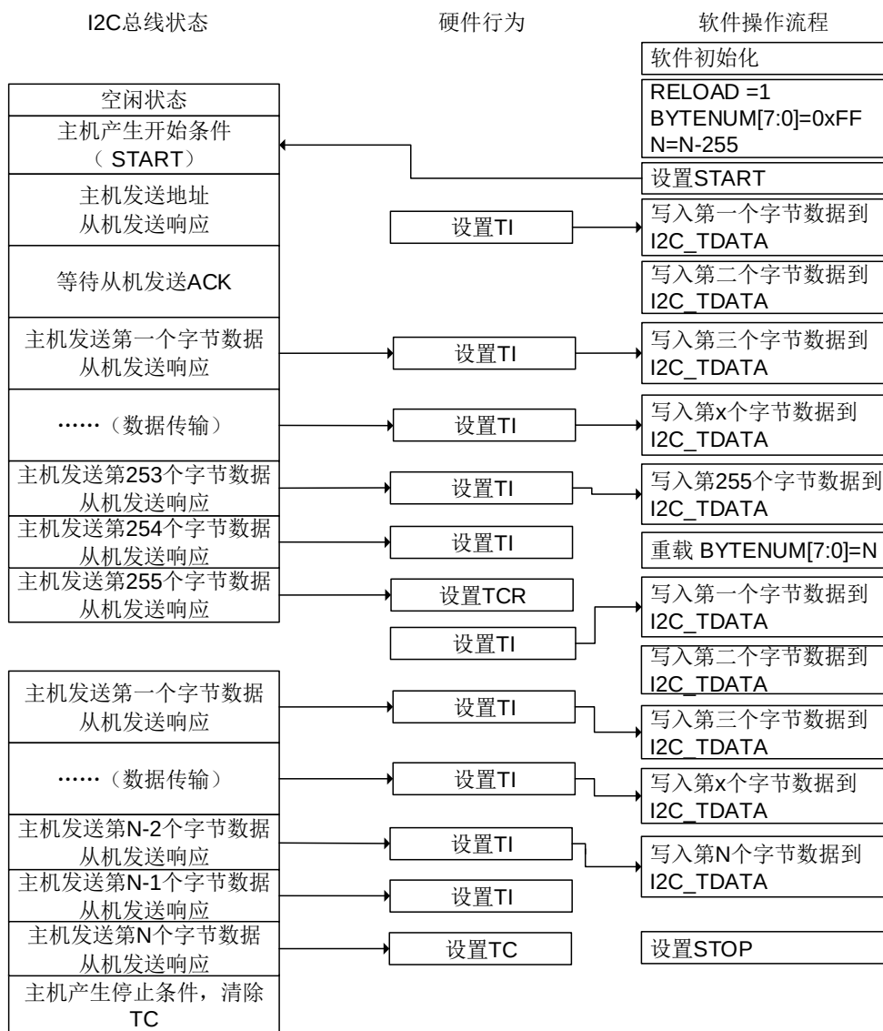
图 21-32. I2C 主机发送编程模型 (N&gt;255)
