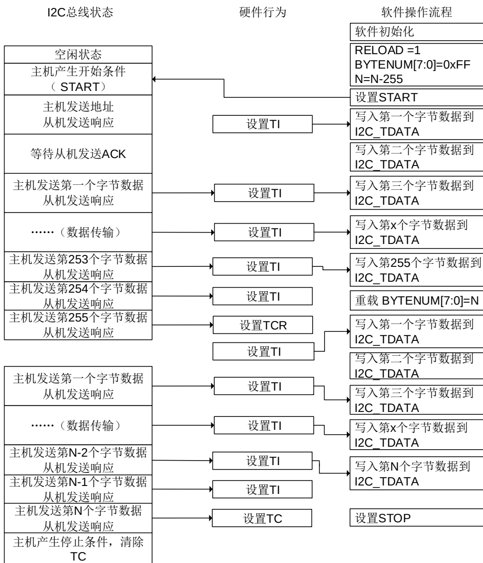
图 21-32. I2C 主机发送编程模型 (N&gt;255)
