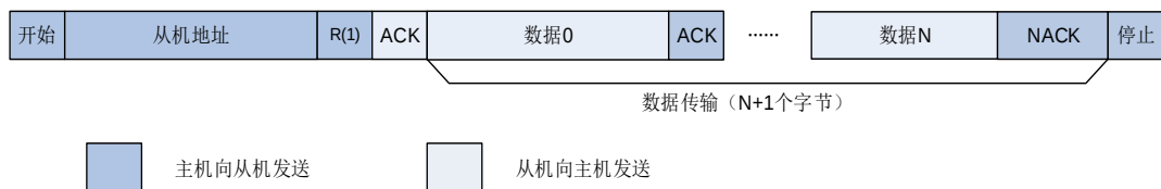
图 21-19. 7 位地址的 I2C 通讯流程（主机接收）
