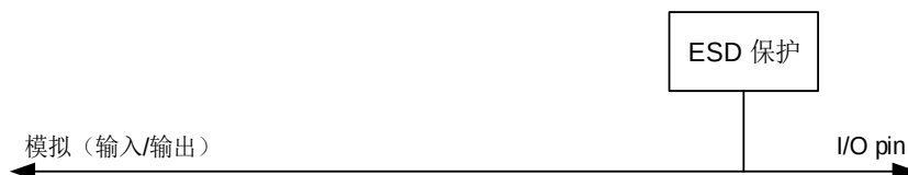
图 8-4. 模拟配置的基本结构
