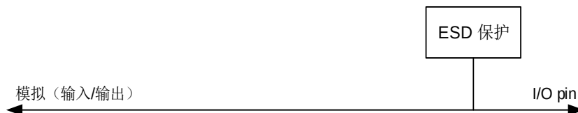
图 8-4. 模拟配置的基本结构
