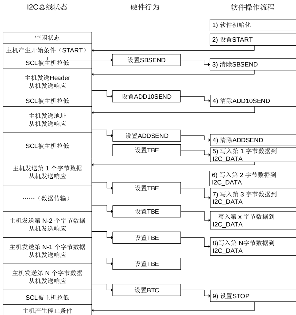
图 21-11. 主机发送模式（10 位地址模式）
