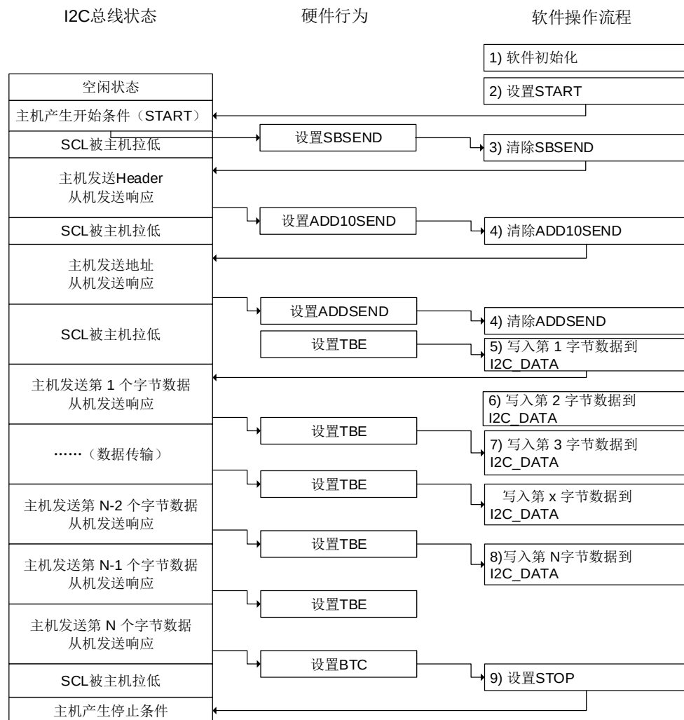
图 24-11. 主机发送模式（10 位地址模式）
