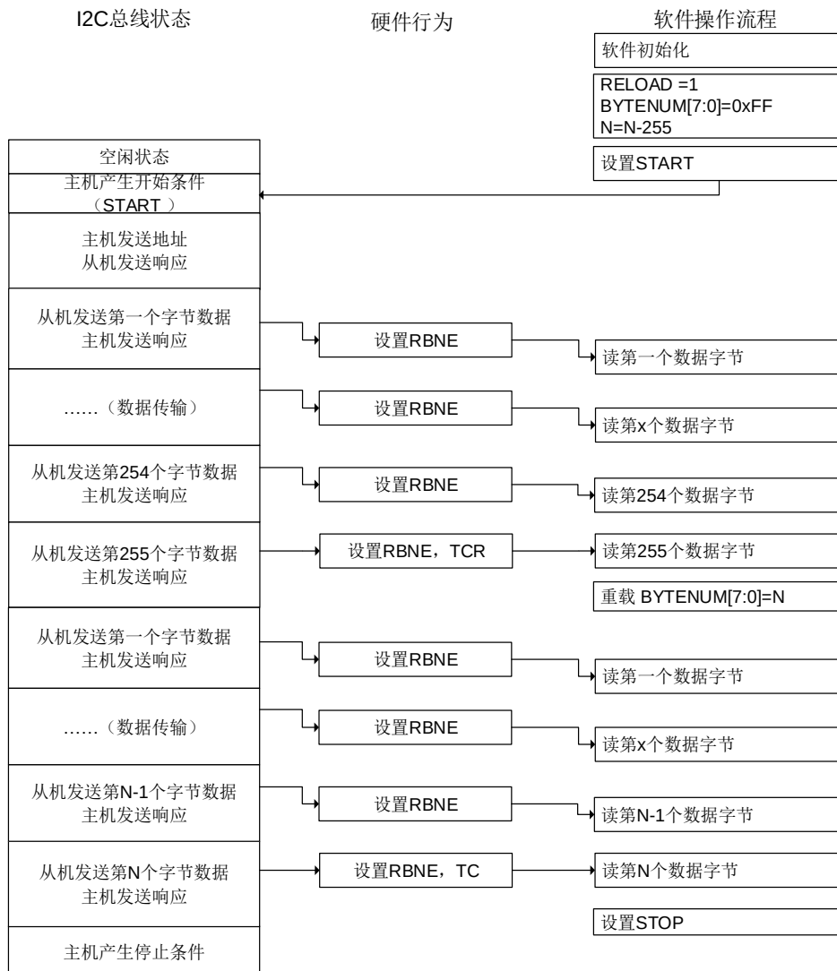
图 24-34. I2C 主机接收编程模型 (N&gt;255)
