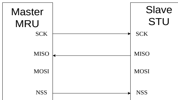
图 25-6. 典型的单工模式连接（主机：只发送，从机：接收）
