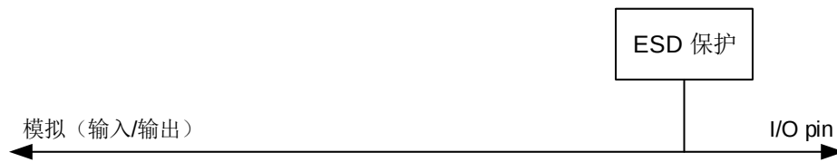
图 8-4. 模拟配置的基本结构
