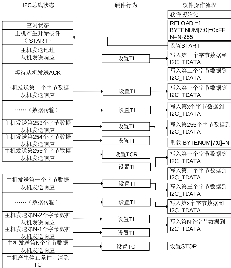
图 24-32. I2C 主机发送编程模型 (N&gt;255)
