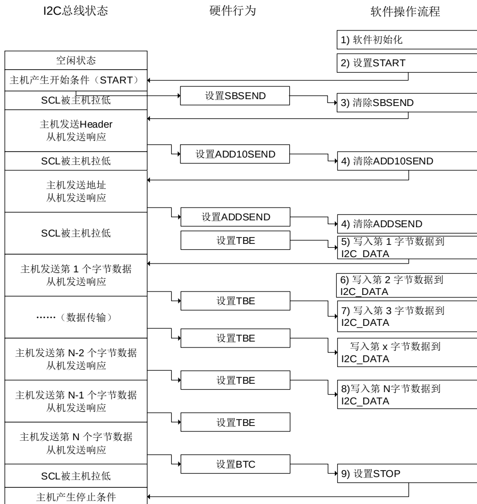
图 20-11. 主机发送模式（10 位地址模式）
