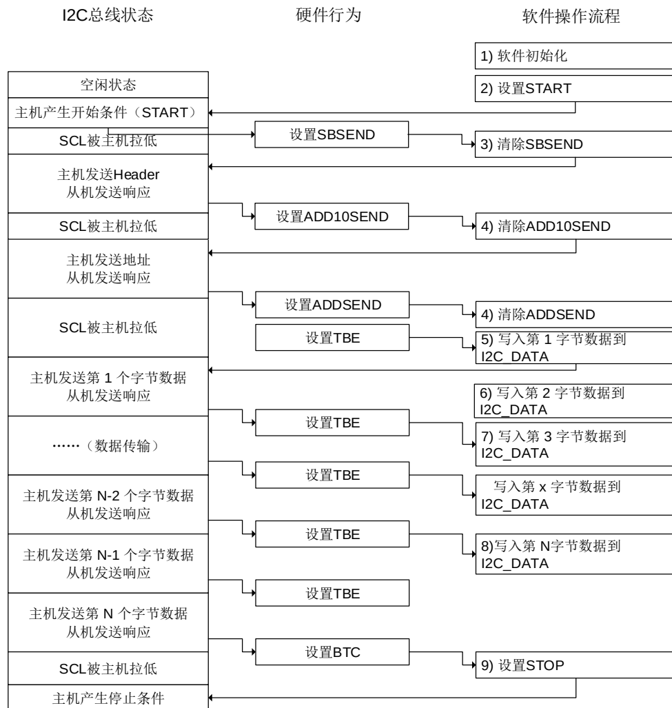
图 20-11. 主机发送模式（10 位地址模式）
