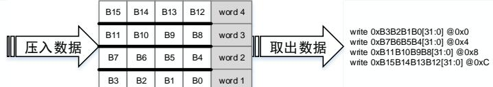
假设当 CNT 被设置为 8, PWIDHT 为‘0b01’, PNAGA 和 MNAGA 被置 1。对于不同的 WIDTH, DMA 的传输操作如 [图 10-5. PWIDHT 为‘0b01’时，数据的打包/解包](#) 所示。
