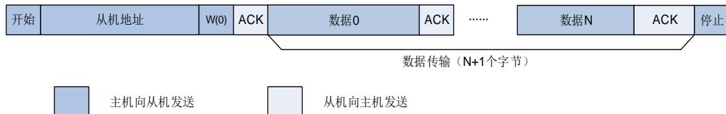
**图 17-6. 7 位地址的 I2C 通讯流程（主机接收）**
