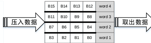
图 10-4. PWIDTH 为'0b00'时, 数据的打包 / 解包
