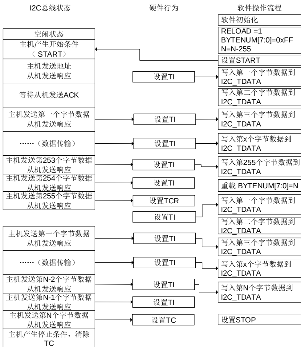
图 17-19. I2C 主机发送编程模型 (N&gt;255)
