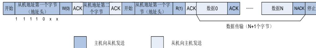
**图 17-8. 10 位地址的 I2C 通讯流程（主机接收，HEAD10R = 1）**
