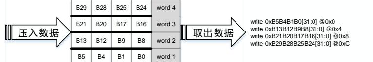
■ 当 CNT 被设置为 4, PWIDHT 为 ‘0b10’, PNAGA 和 MNAGA 被置 1。对于不同的 MWIDTH, DMA 的传输操作如 [图 10-6. PWIDHT 为‘0b10’时，数据的打包/解包](#) 所示。
