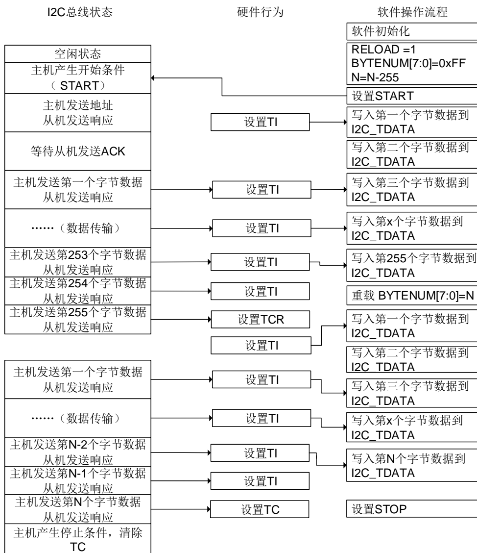
图 20-19. I2C 主机发送编程模型 (N>255)
