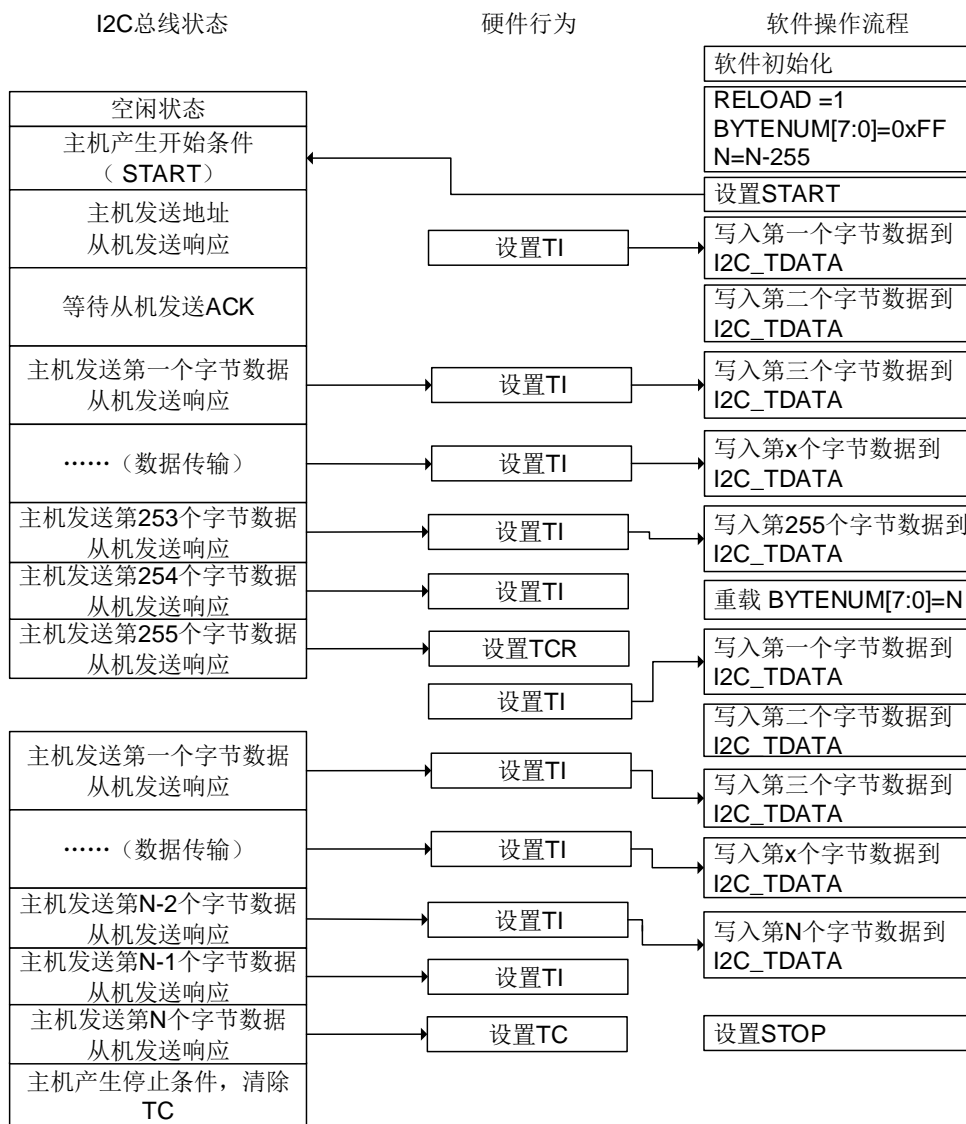
图 26-19. I2C 主机发送编程模型 (N>255)
