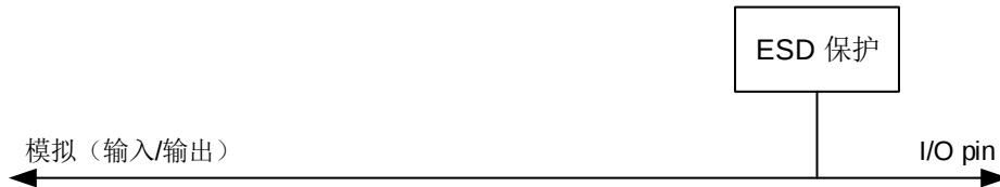
图 8-4. 模拟配置的基本结构
