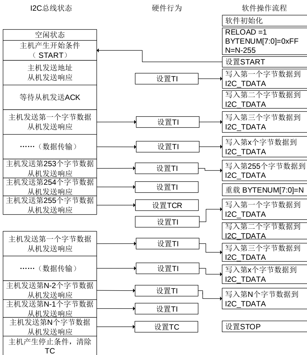
图 20-19. I2C 主机发送编程模型 (N&gt;255)
