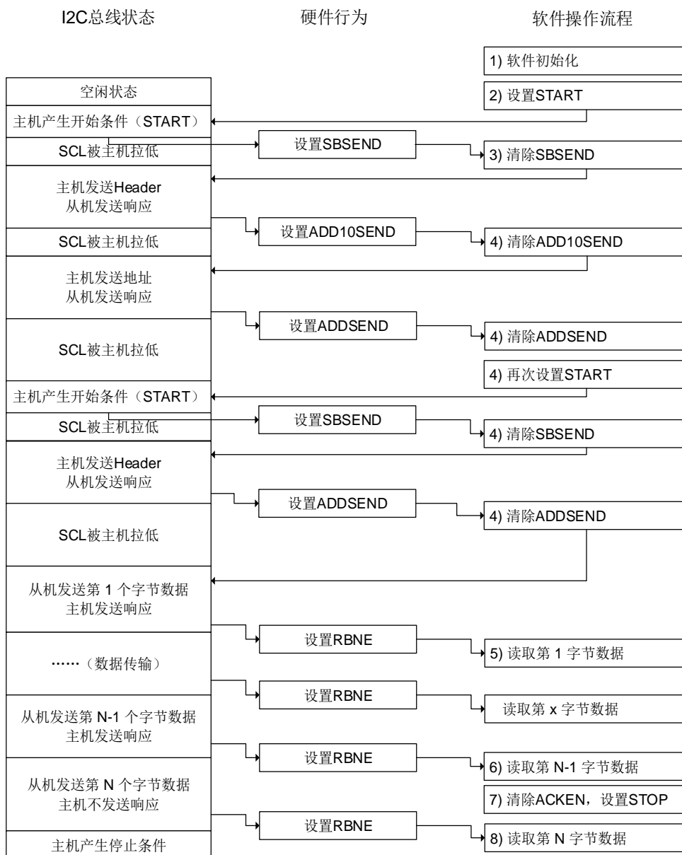
图 17-28. 主机接收使用方案 A 模式（10 位地址模式）
