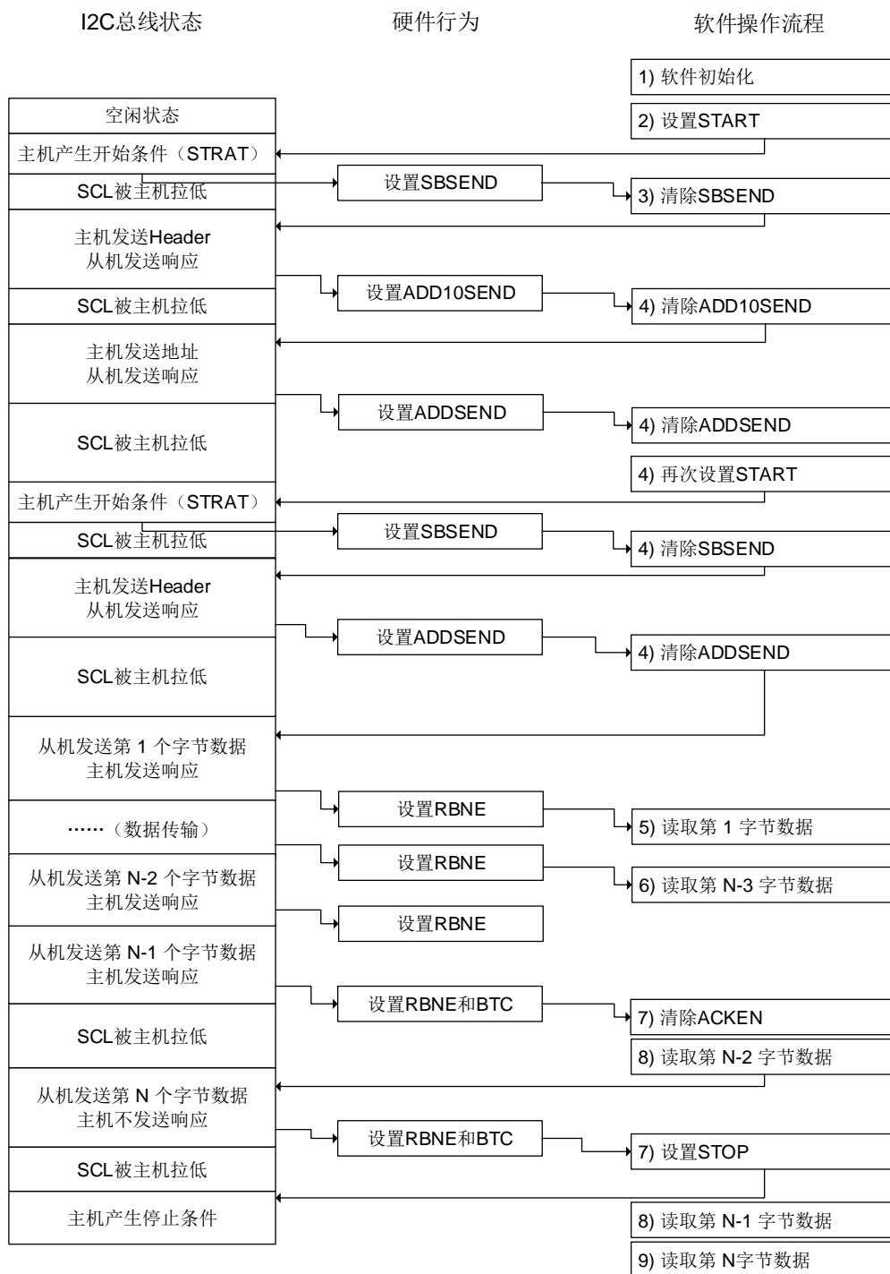
图 17-29. 主机接收使用方案 B 模式（10 位地址模式）
