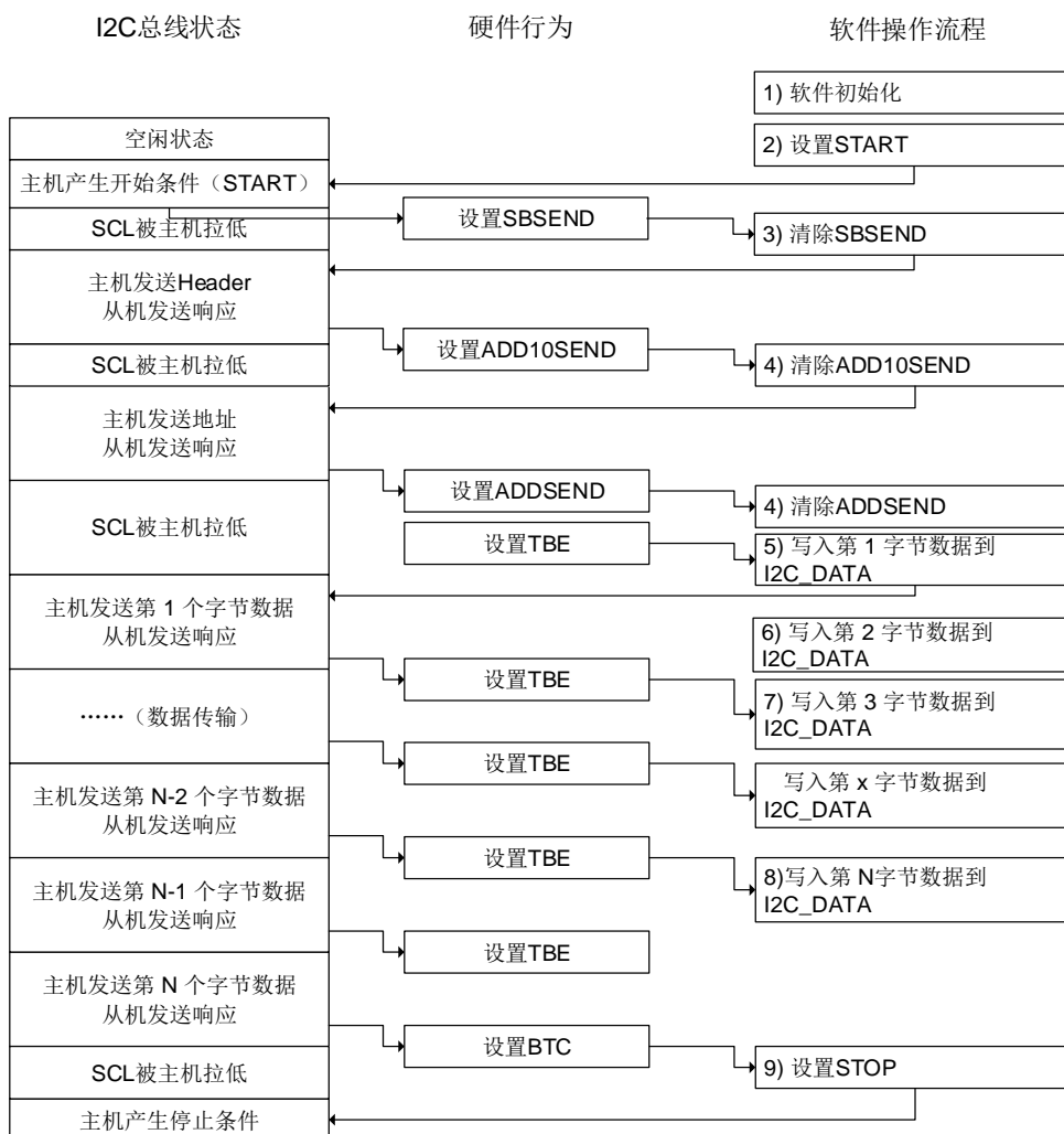
图 17-27. 主机发送模式（10 位地址模式）
