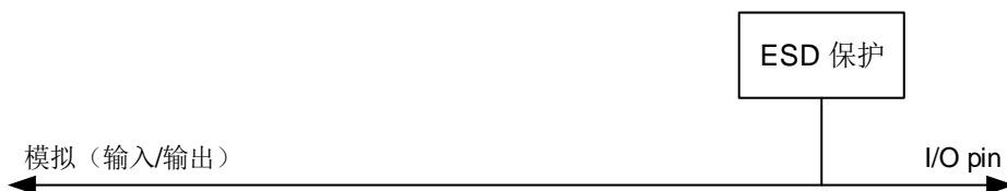
图 8-4. 模拟配置的基本结构
