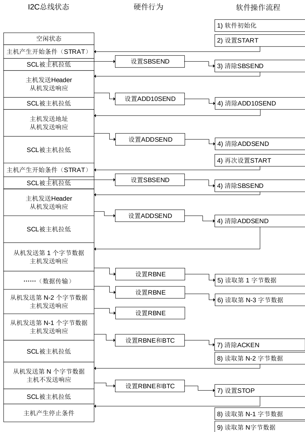
图 18-13. 主机接收使用方案 B 模式（10 位地址模式）
