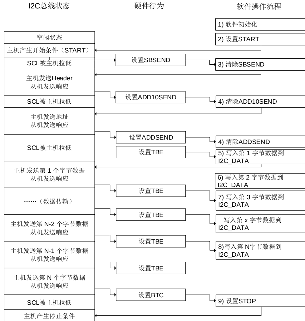
图 18-11. 主机发送模式（10 位地址模式）
