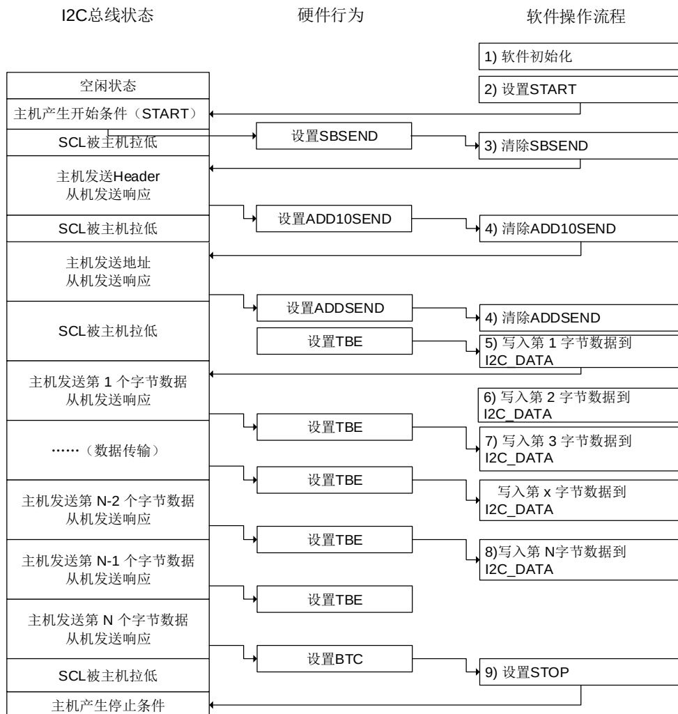
图 18-11. 主机发送模式（10 位地址模式）
