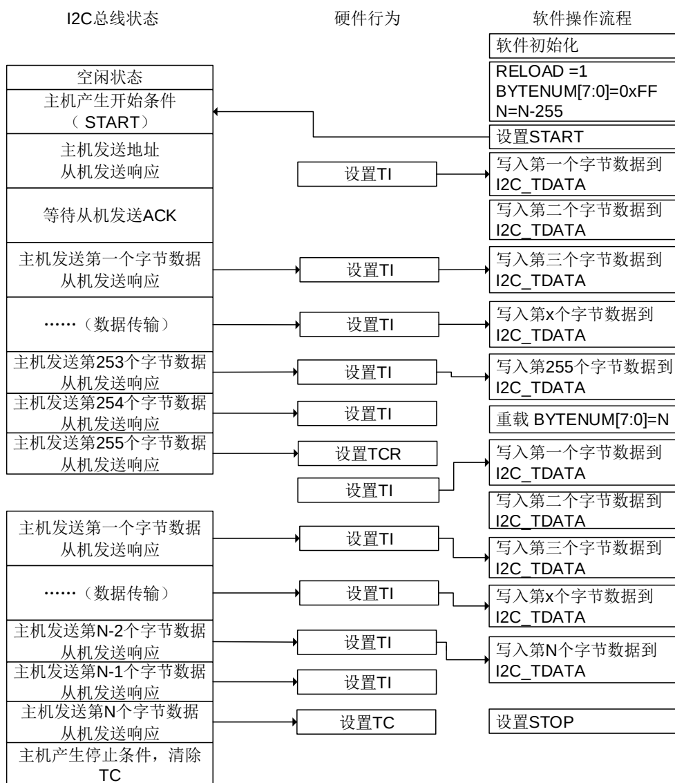
图 21-32. I2C 主机发送编程模型 (N&gt;255)
