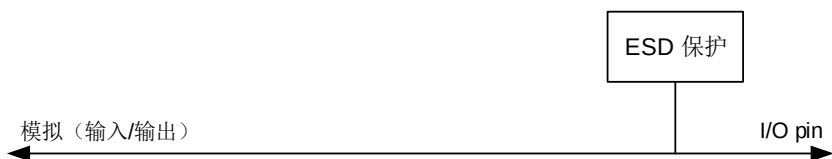
图 8-4. 模拟配置的基本结构
