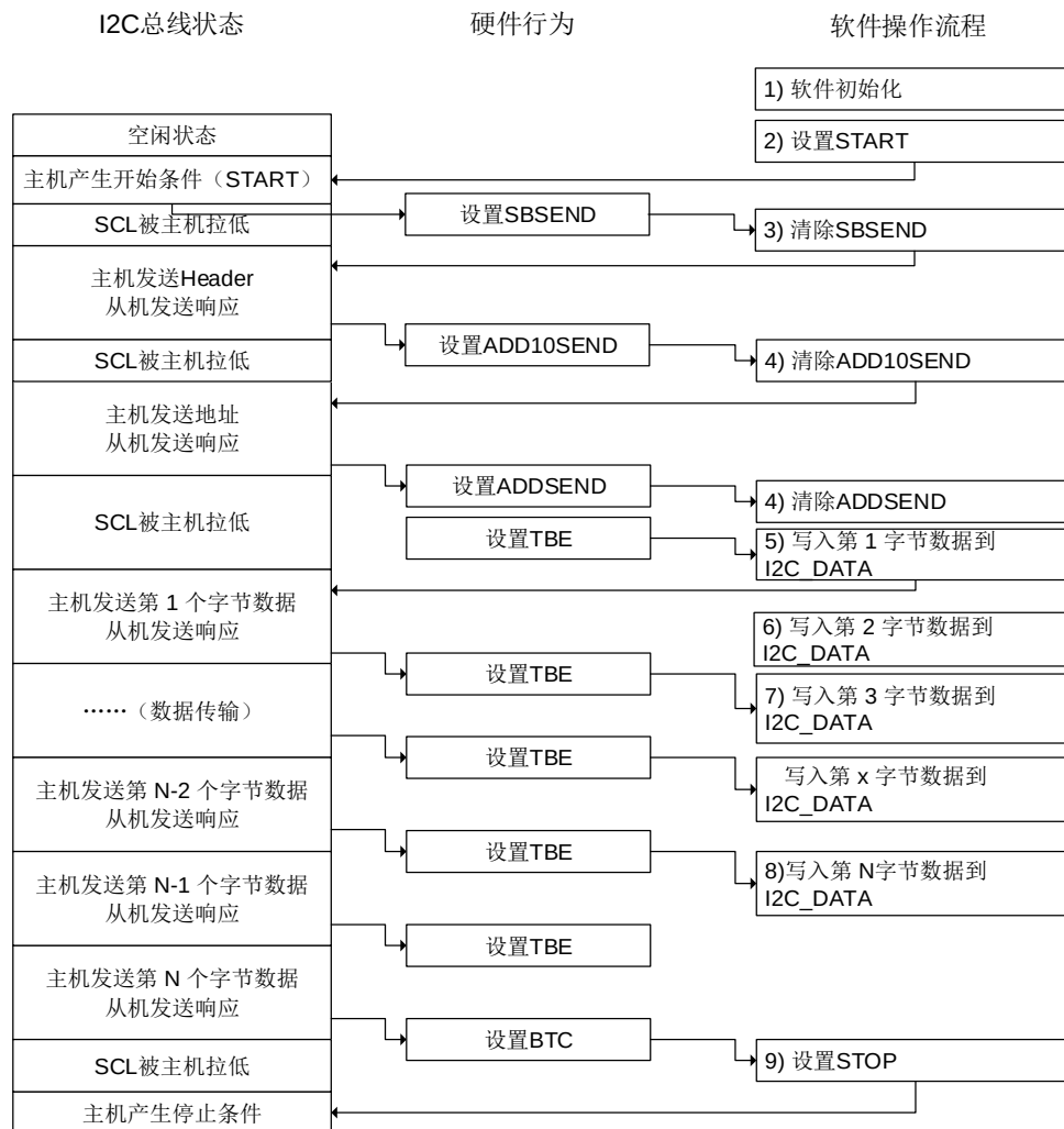
图 17-27. 主机发送模式（10 位地址模式）
