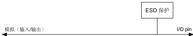
图 7-4. 模拟配置的基本结构
