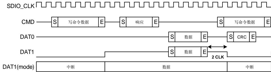
当在 4 位 SD 模式传送数据的多个块时，需要中断周期的特定的定义。为了运行通信的最高速度，中断周期限制在 2 个时钟周期。卡如果想向主机发送一个中断信号，应该在第一个时钟周期设置 DAT1 为低，第二个时钟周期设置 DAT1 为高。然后卡应释放 DAT1 进入 Hi-Z 状态。
