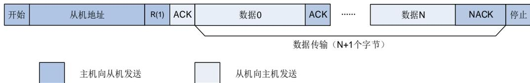
在 10 位寻址模式中，配置 HEAD10R 位可以选择执行完整的寻址序列或只发送地址头。当 HEAD10R=0，执行完整的 10 位地址寻址读序列 START+10 位地址头（写）+第二个地址字节+RESTART+10 位地址头（读），如 [图 21-20. 10 位地址的 I2C 通讯流程\(主机接收, HEAD10R=0\)](#) 所示。
