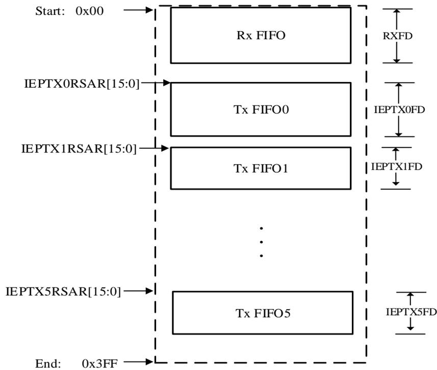
在 DMA 模式下，DMA 负责系统存储区和数据 FIFO 之间的数据包传输。在非 DMA 模式下，程序将包数据写入数据 FIFO 或从数据 FIFO 读取包数据。USBHS 为程序提供了专有寄存器空间来读写数据 FIFO。图 29-9. 设备模式 FIFO 访问寄存器映射表所描述的是数据 FIFO 所访问的寄存器存储空间，图中的数值是以字节为单位寻址。每个端点都拥有它们的 FIFO 访问寄存器空间。通过寄存器 USBHS\_GRXTATR/USBHS\_GRSTATP 来访问 Rx FIFO。
