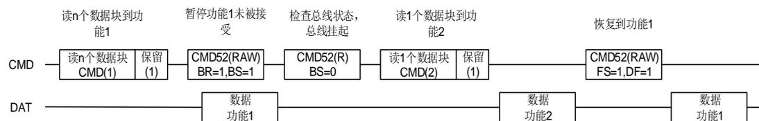
当主机向卡发送数据时，主机可以暂停写操作。设置 SDIO\_CMDCTL[11]位并指示 CSM 当前的命令是一个暂停命令。CSM 分析响应，当从卡收到响应时(暂停被接受)，它确认 DSM 在收到当前数据块的 CRC 后进入空闲状态。
