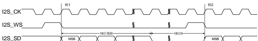
长帧同步模式的各种配置情况时序图如下所示。
