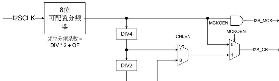
I2S 时钟生成器框图如 [图 22-51. I2S 时钟生成结构框图](#) 所示。I2S 接口时钟是通过 SPI\_I2SPSC 寄存器的 DIV 位，OF 位和 MCKOEN 位以及 SPI\_I2SCTL 寄存器的 CHLEN 位来配置的。时钟源是系统时钟 CK\_SYS 或 PLL2\*2。I2S 比特率可以通过 [表 22-7. I2S 比特率计算公式](#) 所示的公式计算。
