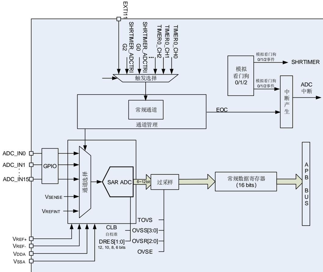
图 13-2. ADC 模块框图 (ADC2)
