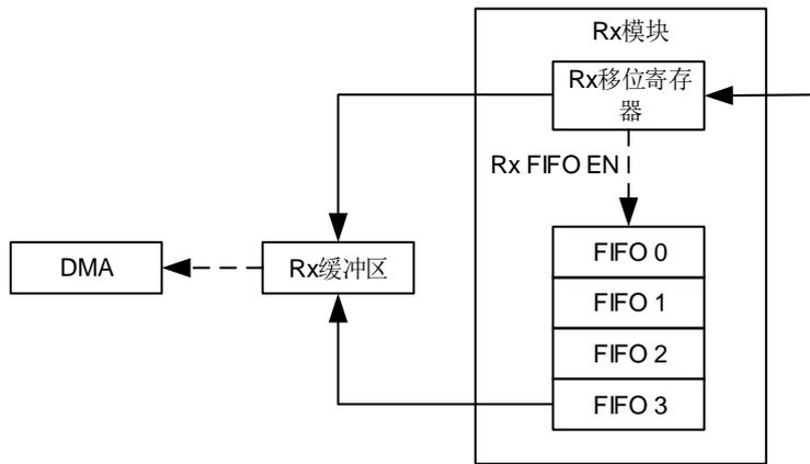
如果软件在响应 RBNE 中断时读数据接收缓冲区，在响应开始时，RBNEIE 位应清 0。当所有接收的数据被读出后，RBNEIE 位应置位。在读出接收的数据前，PERR, NERR, FERR, EBF 都应被清 0。
