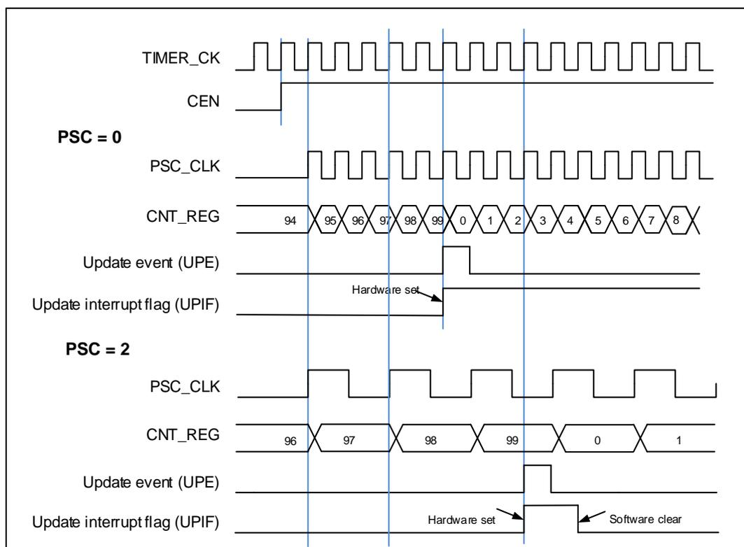
图 18-102. 向上计数时序图，在运行时改变 TIMERx\_CAR 寄存器的值
