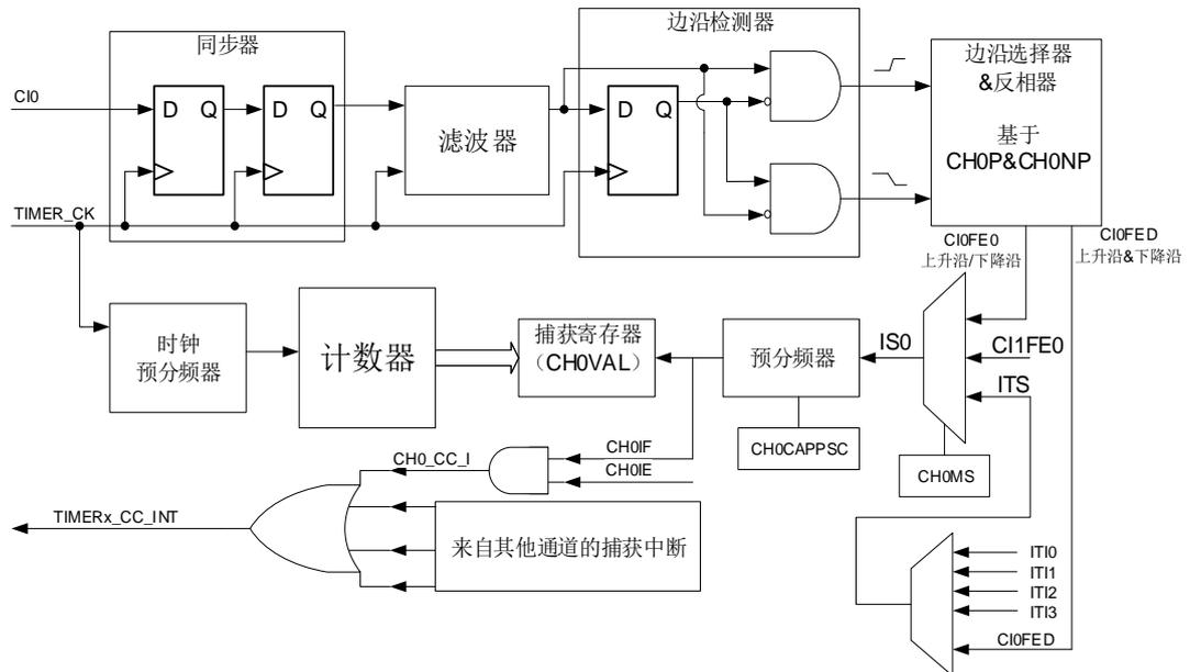
通道输入信号  $Cix$  有两种选择，一种是  $TIMERx\_CHx$  信号，另一种是  $TIMERx\_CH0$ ,  $TIMERx\_CH1$  和  $TIMERx\_CH2$  异或之后的信号。通道输入信号  $Cix$  先被  $TIMER\_CK$  信号同步，然后经过数字滤波器采样，产生一个被滤波后的信号。通过边沿检测器，可以选择检测上升沿或者下降沿。通过配置  $CHxP$  选择使用上升沿或者下降沿。配置  $CHxMS$ ，可以选择其他通道的输入信号，内部触发信号。配置  $IC$  预分频器，使得若干个输入事件后才产生一个有效的捕获事件。捕获事件发生， $TIMERx\_CHxCV$  存储计数器的值。
