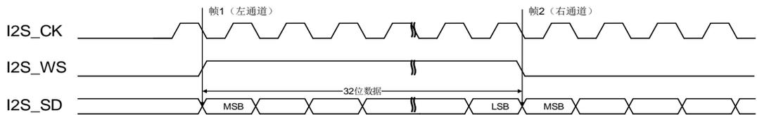
图 22-26. MSB 对齐标准时序图 (DTLEN=10, CHLEN=1, CKPL=1)
