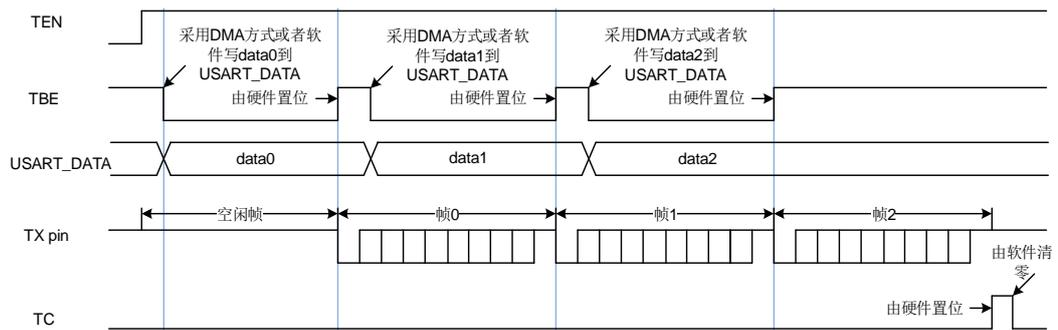
在禁用 USART 或进入低功耗状态之前，必须等待 TC 置位。先读 USART\_STAT0 然后再写 USART\_DATA 可将 TC 位清 0。在多级缓存通信方式（DENT=1）下，直接向 TC 写 0，也能清 TC。
