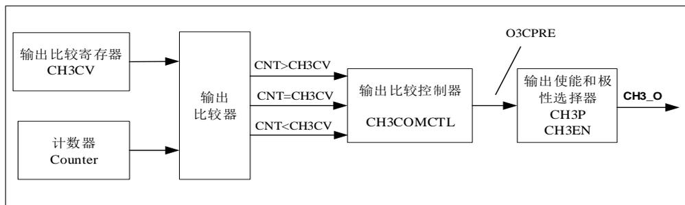
图 18-13. 输出比较原理（带有互补输出的通道，x=0,1,2）和图 18-14. 输出比较原理分别给出了输出比较的逻辑电路。通道输出信号 CHx\_O/CHx\_ON 与 OxCPRE 信号（详情请见[通道输准备信号](#)）的关系描述如下：OxCPRE 信号高电平有效，CHx\_O/CHx\_ON 的输出情况与 OxCPRE 信号，CHxP/CHxNP 位和 CHxEN/CHxNEN 位有关（具体情况请见 TIMERx\_CHCTL2 寄存器中的描述）。例如：
