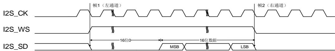
**图 22-34. LSB 对齐标准时序图 (DTLEN=00, CHLEN=1, CKPL=1)**
