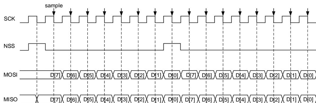
在主机 TI 模式下，SPI 模块可实现连续传输或者不连续传输。如果主机写 SPI\_DATA 的速度很快，那么就是连续传输，否则，为不连续传输。在不连续传输中，在每个字节传输前需要一个额外的时钟周期。在连续传输中，额外的时钟周期只存在于第一个字节之前，随后字节的起始时钟周期被前一个字节的最后一位的时钟周期覆盖。
