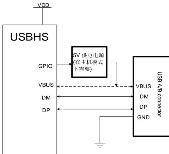
当 USBHS 工作在主机模式下时（FHM 控制位置位、FDM 控制位置清除），VBUS 为 USB 协议所定义的 5V 电源检测引脚。内部 PHY 不能提供 5V VBUS 电源，仅在 VBUS 信号线上具有电压比较器和充电、放电电路。所以，如果应用需要提供 VBUS 电源，那么则需要一个外部的供电电源 IC。在主机模式下，USBHS 和 USB 接头之间的 VBUS 连接可以被忽略，这是由于 USBHS 并不检测 VBUS 引脚的电平状态，并假定 5V 供电电源一直存在。
