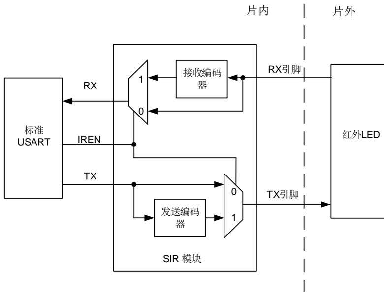
在 IrDA 模式下，TX 引脚电平与 RX 引脚不同。TX 引脚通常为低电平，RX 引脚通常为高电平。IrDA 引脚电平保持稳定代表逻辑 ‘1’，红外光源脉冲（RTZ 信号）代表逻辑 ‘0’。其脉冲宽度通常占一个位时间的 3/16。IrDA 无法检测到宽度小于一个 1 个 PSC 时钟的脉冲。如果脉冲宽度大于 1 但是小于 2 倍 PSC 时钟，IrDA 则无法可靠的检测到。
