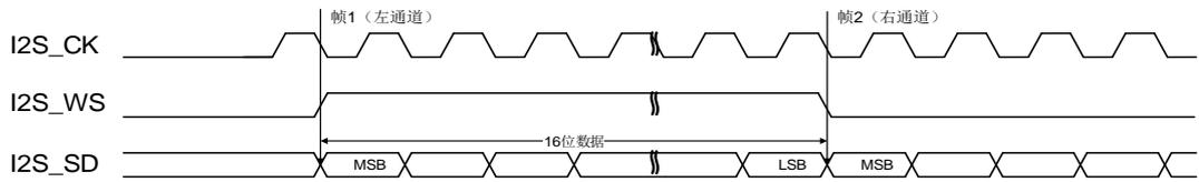
图 22-24. MSB 对齐标准时序图 (DTLEN=00, CHLEN=0, CKPL=1)
