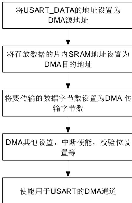
当 USART 接收到的数据数量达到了 DMA 传输数据数量，DMA 模块将产生传输完成中断。
