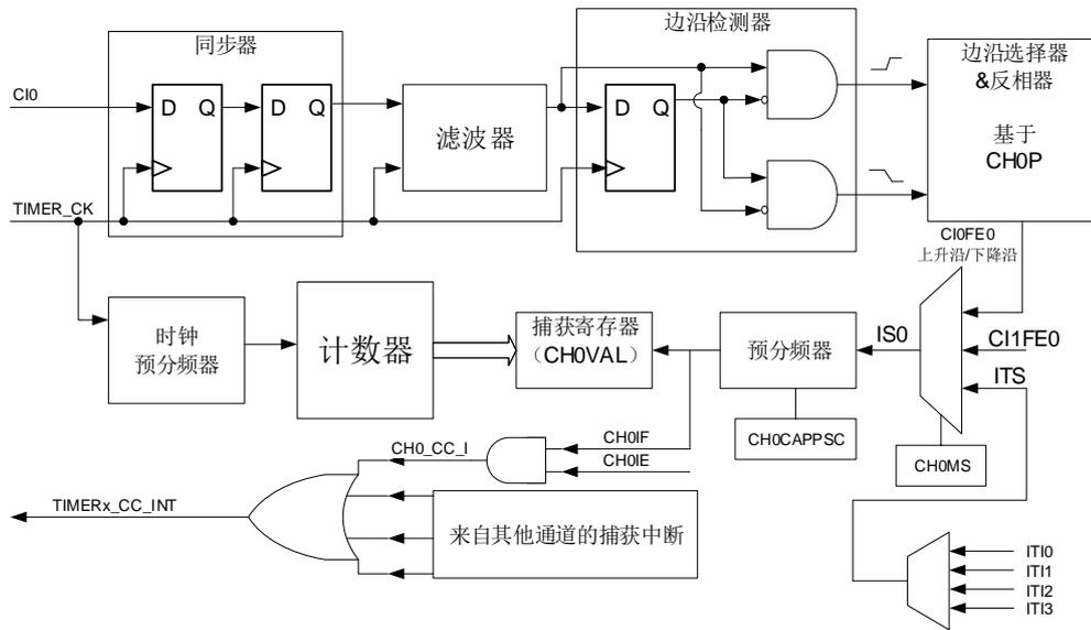
通道输入信号  $Cix$  有两种选择，一种是  $TIMERx\_CHx$  信号，另一种是  $TIMERx\_CH0$ ,  $TIMERx\_CH1$  和  $TIMERx\_CH2$  异或之后的信号。通道输入信号  $Cix$  先被  $TIMER\_CK$  信号同步，然后经过数字滤波器采样，产生一个被滤波后的信号。通过边沿检测器，可以选择检测上升沿或者下降沿。通过配置  $CHxP$  选择使用上升沿或者下降沿。配置  $CHxMS$ ，可以选择其他通道的输入信号，内部触发信号。配置  $IC$  预分频器，使得若干个输入事件后才产生一个有效的捕获事件。捕获事件发生， $CHxVAL$  存储计数器的值。
