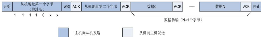
**图 21-8. 10 位地址的 I2C 通讯流程 (主机接收)**
