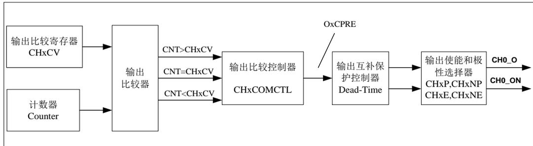
图18-92. 通道输出比较原理（带有互补输出的通道， $x=0$ ）给出了输出比较的原理电路。通道输出信号 `CHx_O/CHx_ON` 与 `OxCPRE` 信号（详情请见[通道输出准备信号](#)）的关系描述如下：`OxCPRE` 信号高电平有效，`CHx_O/CHx_ON` 的输出情况与 `OxCPRE` 信号，`CHxP/CHxNP` 位和 `CHxE/CHxNE` 位有关（具体情况请见 `TIMERx_CHCTL2` 寄存器中的描述）。例如：
