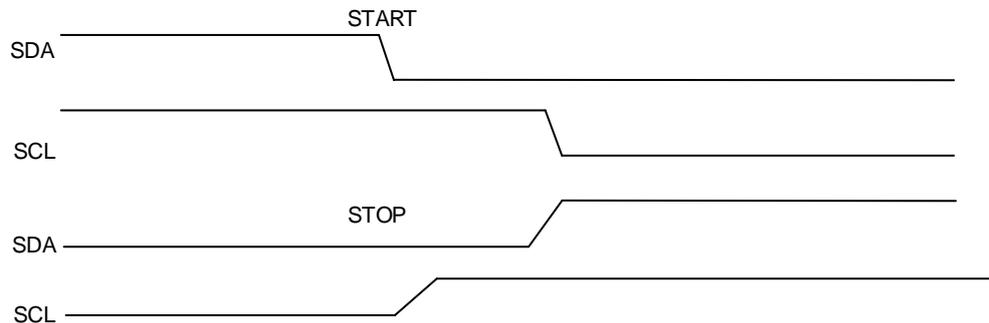
每个 I2C 设备（不管是微控制器，LCD 驱动，存储器或者键盘接口）都通过唯一的地址进行识别，根据设备功能，他们既可以是发送器也可作为接收器。在默认情况下，I2C 设备工作在从机模式下。当 START 信号产生时，I2C 设备由从机模式切换成主机模式。如果仲裁丢失或者 STOP 信号产生时，I2C 由主机模式切换成从机模式。支持 I2C 多主机模式。
