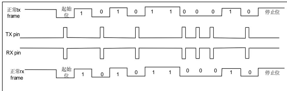
将 USART\_CTL2 寄存器中 IRLP 置位可以使 SIR 子模块工作在低功耗模式下。发送编码器由 PCLK 分频得到的低速时钟来驱动。分频系数在 USART\_GP 寄存器中 PSC[7:0]位配置。TX 引脚脉冲宽度可以为低功耗波特率的 3 倍。接收器解码器工作模式与正常 IrDA 模式相同。
