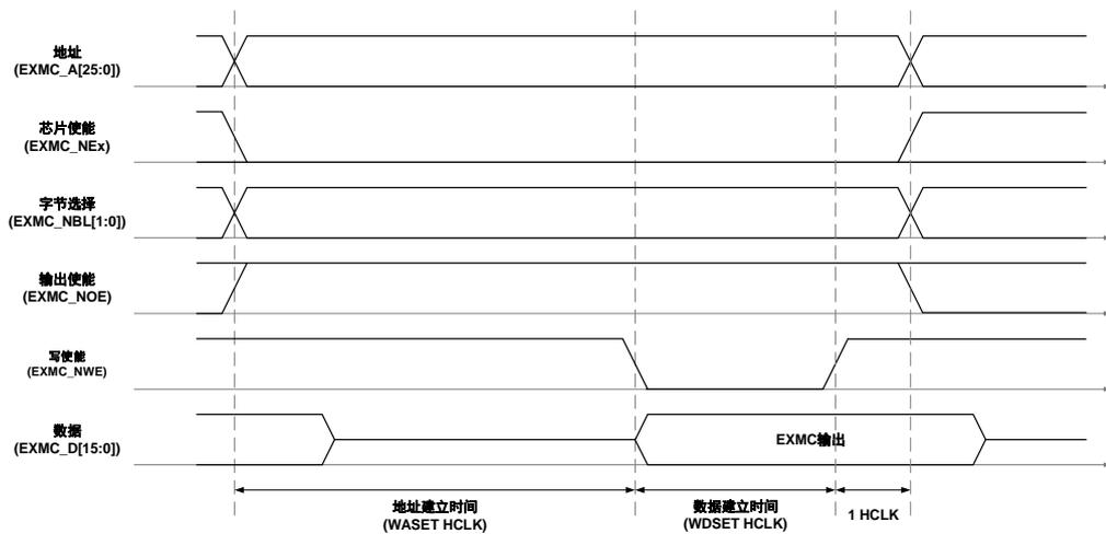
模式 A 和模式 1 的区别在于写时序，当两个模式的寄存器有相同的时序配置时，模式 A 的写时序独立于读时序。
