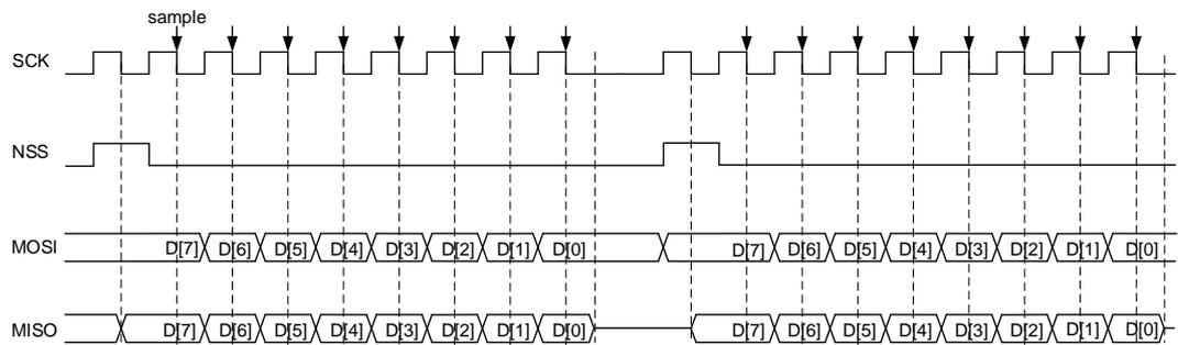
图 22-9. 主机 TI 模式在连续发送时的时序图
