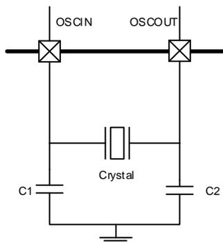
HXTAL 晶体振荡器可以通过设置控制寄存器 RCU\_CTL 的 HXTALEN 位来启动或关闭，在控制寄存器 RCU\_CTL 中的 HXTALSTB 位用来指示外部高速振荡器是否已稳定。在启动时，直到这一位被硬件置‘1’，时钟才被释放出来。这个特定的延迟时间被称为振荡器的启动时间。当 HXTAL 时钟稳定后，如果在中断寄存器 RCU\_INT 中的相应中断使能位 HXTALSTBIE 位被置‘1’，将会产生相应中断。此时，HXTAL 时钟可以被直接用作系统时钟源或者 PLL 输入时钟。
