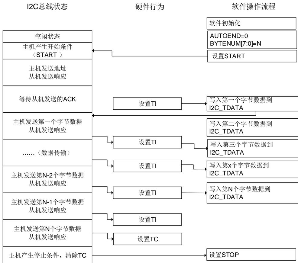
图 21-32. I2C 主机发送编程模型 (N&gt;255)
