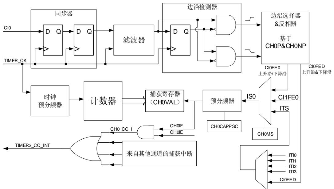
通道输入信号  $Cix$  先被  $TIMER\_CK$  信号同步，然后经过数字滤波器采样，产生一个被滤波后的信号。通过边沿检测器，可以选择检测上升沿或者下降沿。通过配置  $CHxP$  选择使用上升沿或者下降沿。配置  $CHxMS$ ，可以选择其他通道的输入信号，内部触发信号。配置  $IC$  预分频器，使得若干个输入事件后才产生一个有效的捕获事件。捕获事件发生， $TIMERx\_CHxCV$  存储计数器的值。
