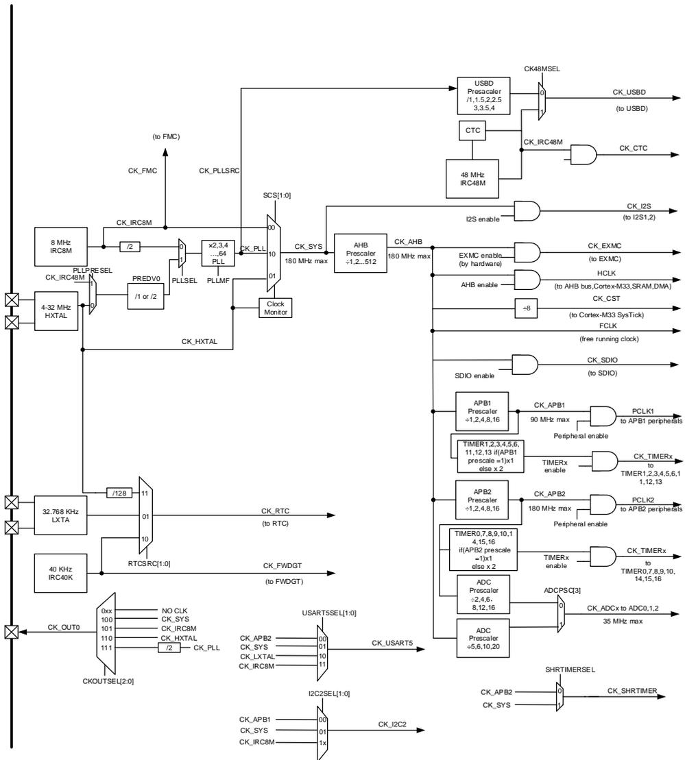
预分频器可以配置 AHB、APB2 和 APB1 域的时钟频率。AHB、APB2、APB1 域的最高时钟频率分别为 180MHz、180MHz、90MHz。RCU 通过 AHB 时钟 (HCLK) 8 分频后作为 Cortex® 系统定时器 (SysTick) 的外部时钟。通过对 SysTick 控制和状态寄存器的设置, 可选择上述时钟或 AHB (HCLK) 时钟作为 SysTick 时钟。
