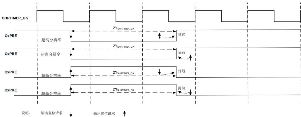
如果输出置位和复位请求的时间间隔大于两个完整的  $t_{HPTMER\_CK}$  周期，则需要使用超高分辨率时钟。具体如 [图 19-23. 超高分辨率 OXPRE 波形](#) 所示。
