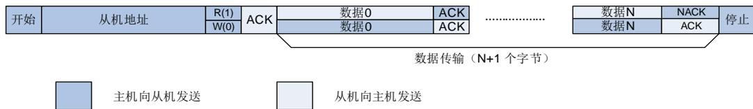
**图 21-7. 10 位地址的 I2C 通讯流程 (主机发送)**
