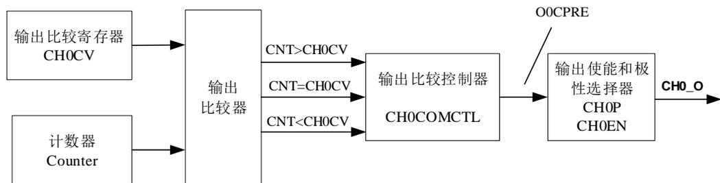
图 18-66. 通道输出比较原理给出了输出比较的逻辑电路。通道输出信号 CHx\_O 与 OxCPRE 信号（详情请见通道输出准备信号）的关系描述：OxCPRE 信号高电平有效，CHx\_O 的输出情况与 OxCPRE 信号，CHxP 位和 CHxEN 位有关（具体情况请见 TIMERx\_CHCTL2 寄存器中的描述）。例如，当设置 CHxP=0（CHx\_O 高电平有效，与 OxCPRE 输出极性相同）、CHxEN=1（CHx\_O 输出使能）时：
