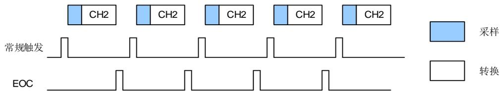
常规通道单次转换结束后，转换数据将被存放于 ADC\_RDATA 寄存器中，EOC 将会置 1。如果 EOCIE 位被置 1，将产生一个中断。
