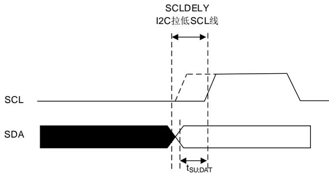
当内部检测到 SCL 下降沿时，在 SDA 发送之前会插入一个延时。该延时为  $t_{SDADELY} = SDADELY * t_{PSC} + t_{I2CCLK}$ ，其中  $t_{PSC} = (PSC + 1) * t_{I2CCLK}$ 。  $t_{SDADELY}$  会影响  $t_{HD;DAT}$ 。 SDA 输出总延时为  $t_{SYNC1} + \{[SDADELY * (PSC + 1) + 1] * t_{I2CCLK}\}$ 。  $t_{SYNC1}$  由 SCL 下降斜率，模拟滤波器延时，数字滤波器延时和 SCL 与 I2CCLK 时钟的同步延时共同决定。 SCL 与 I2CCLK 时钟的同步延时为 2 至 3 个  $t_{I2CCLK}$ 。
