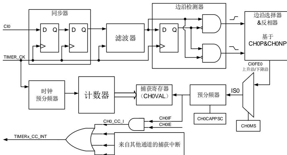
通道输入信号  $Cix$  先被  $TIMER\_CK$  信号同步，然后经过数字滤波器采样，产生一个被滤波后的信号。通过边沿检测器，可以选择检测上升沿或者下降沿。通过配置  $CHxP$  选择使用上升沿或者下降沿。配置  $CHxMS$ ，可以选择其他通道的输入信号，内部触发信号。配置  $IC$  预分频器，使得若干个输入事件后才产生一个有效的捕获事件。捕获事件发生， $TIMERx\_CHxCV$  存储计数器的值。
