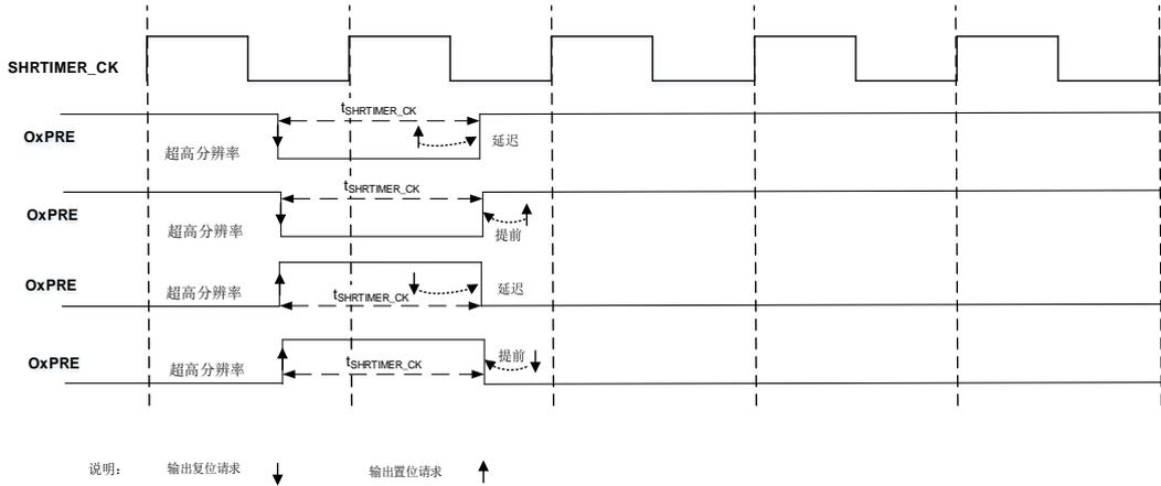
如果输出置位和复位请求的时间间隔包括一个完整的  $t_{SHRTMER\_CK}$  周期，则会生成脉宽为 2 个  $t_{SHRTMER\_CK}$  周期的脉冲。具体如 [图 19-22. 脉冲宽度为 2 个  \$t\_{SHRTMER\\_CK}\$  周期](#) 所示。
