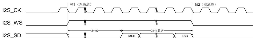
**图 22-32. LSB 对齐标准时序图 (DTLEN=01, CHLEN=1, CKPL=1)**
