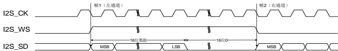
**图 22-30. MSB 对齐标准时序图 (DTLEN=00, CHLEN=1, CKPL=1)**
