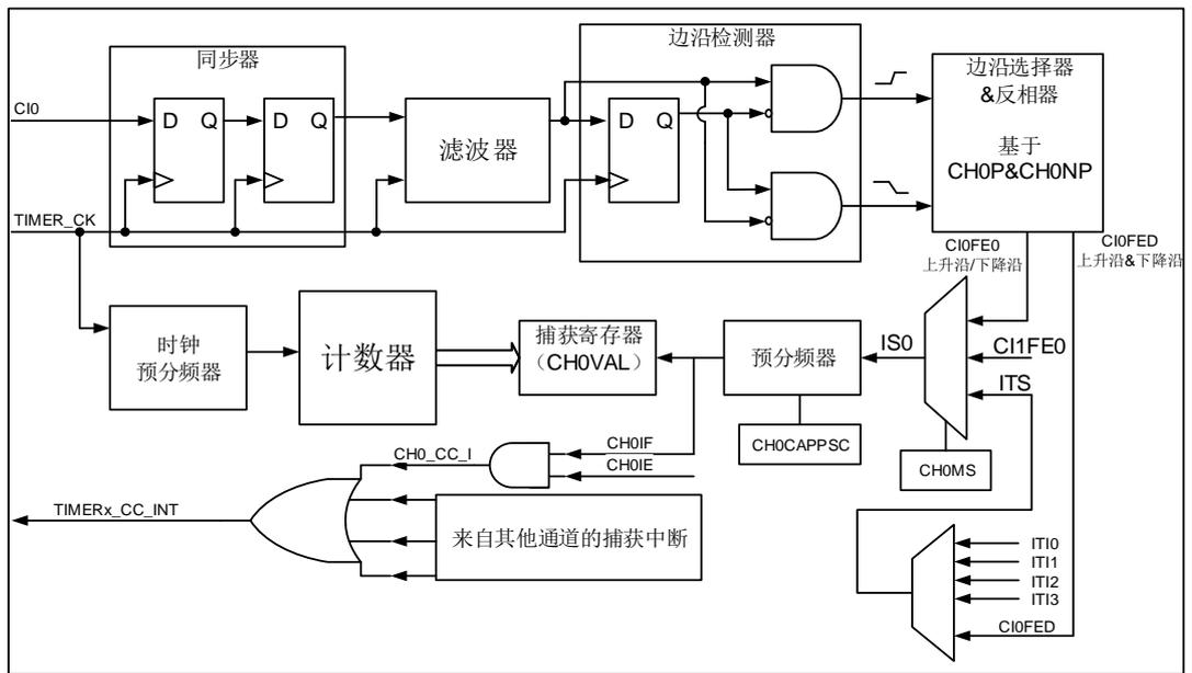
通道输入信号  $Cl_x$  来源于  $TIMERx\_CHx$  信号。通道输入信号  $Cl_x$  先被  $TIMER\_CK$  信号同步，然后经过数字滤波器采样，产生一个被滤波后的信号。通过边沿检测器，可以选择检测上升沿或者下降沿。通过配置  $CHxP$  选择使用上升沿或者下降沿。通过配置  $CHxMS$ ，还可以选择其他通道的输入信号或内部触发信号作为捕获信号。配置  $IC$  预分频器，使得若干个输入事件后才产生一个有效的捕获事件。捕获事件发生， $TIMERx\_CHxCV$  存储计数器的值。
