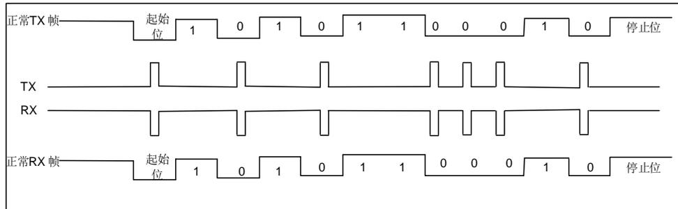
将 USART\_CTL2 寄存器中 IRLP 置位可以使 SIR 子模块工作在低功耗模式下。发送编码器由 PCLK 分频得到的低速时钟来驱动。分频系数在 USART\_GP 寄存器中 PSC[7:0] 位配置。TX 引脚脉冲宽度可以为低功耗波特率的 3 倍。接收解码器工作模式与正常 IrDA 模式相同。
