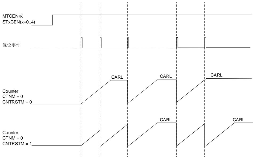
在连续模式下，一旦 SHRTIMER\_MTCTL0 寄存器中的 MTCEN 位置 1，计数器将立即启动。当计数到计数器重载值时，计数器从 0 重新启动，并产生翻转事件。与单脉冲模式不同，随时生成的复位事件将复位并重启计数器。[图 19-5. 连续模式下计数器的动作](#)显示了连续模式下的计数器运行情况。
