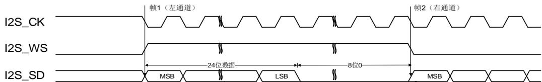
**图 22-29. MSB 对齐标准时序图 (DTLEN=00, CHLEN=1, CKPL=0)**
