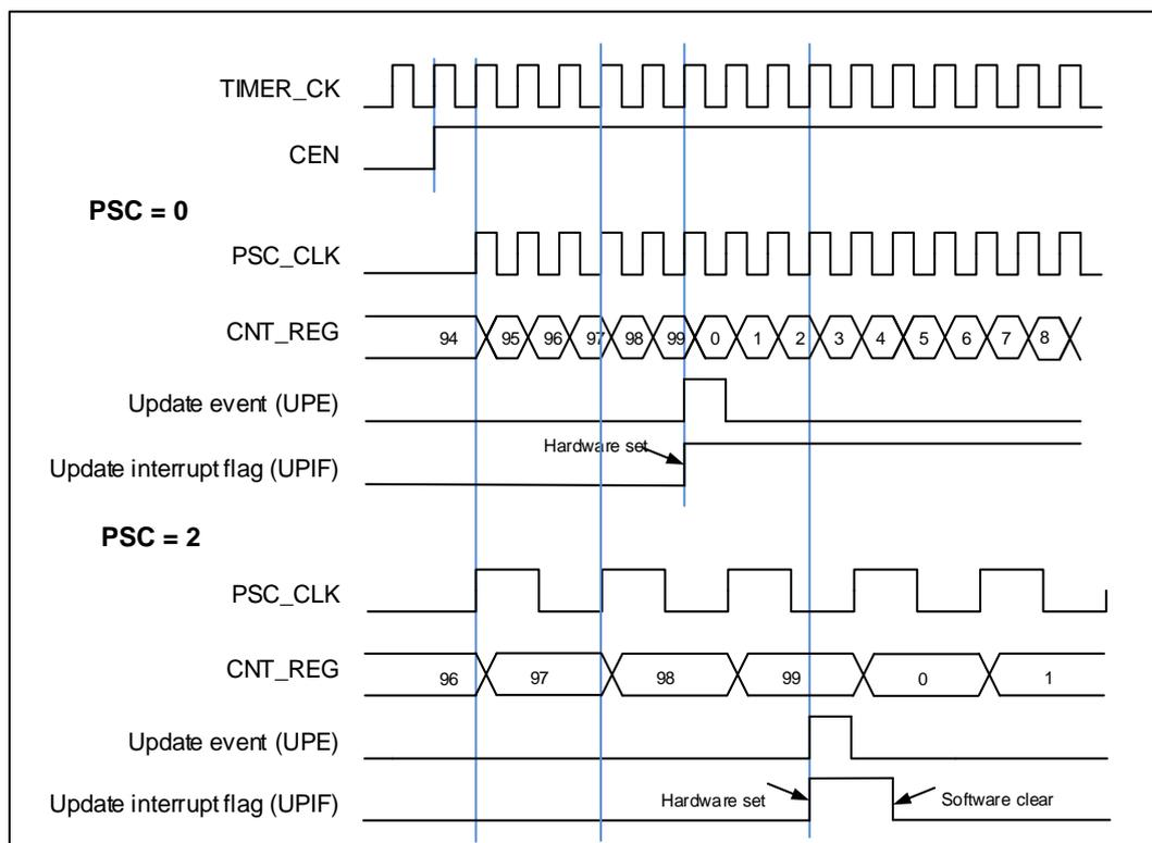
图 18-89. 向上计数时序图，在运行时改变 **TIMERx\_CAR** 寄存器的值
