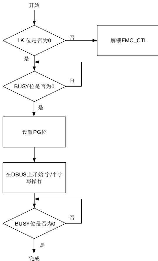
**注意：**避免在同一个 bank 中既进行读操作，又进行擦除/编程操作。当 CPU 进入省电模式时，对闪存的操作将失败。
