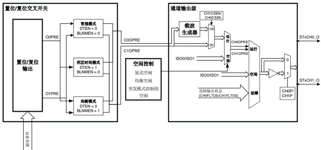
交叉开关模块有三种输出模式：常规模式，死区时间模式和均衡模式，输出时只能选择其中一种模式。
