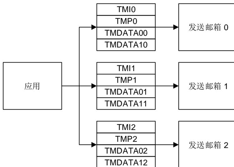
如果想要发送 CAN-FD 帧，使用发送邮箱 x（x 等于 0 到 2）时，仅需要写对应的 TMDATA0x（x 等于 0 到 2）寄存器。例如软件想要使用发送邮箱 0 发送 64 字节数据，需要通过写 TMDATA00 寄存器 16 次将待发送数据写入内部专用 SRAM 区。
