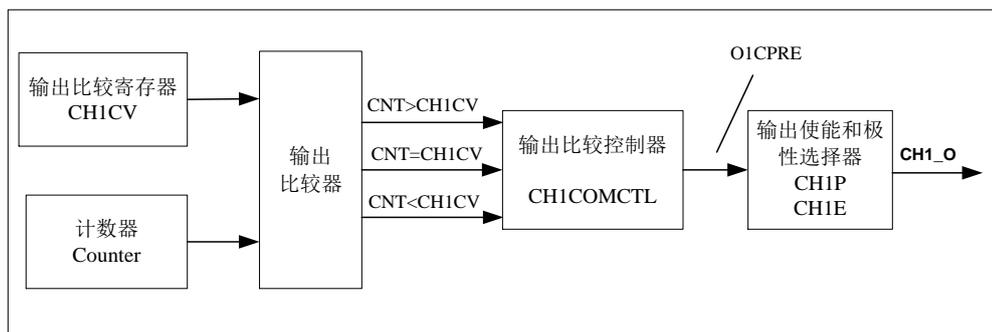
图18-75. 通道输出比较原理 (带有互补输出的通道, x=0) 和 图18-76. 通道输出比较原理 分别给出了输出比较的逻辑电路。通道输出信号 CHx\_O/CHx\_ON 与 OxCPRE 信号 (详情请见 [通道输出准备信号](#)) 的关系描述如下: OxCPRE 信号高电平有效, CHx\_O/CHx\_ON 的输出情况与 OxCPRE 信号, CHxP/CHxNP 位和 CHxE/CHxNE 位有关 (具体情况请见 TIMERx\_CHCTL2 寄存器中的描述)。例如:
