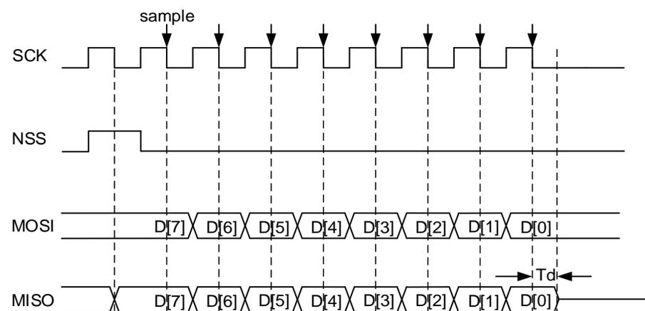
在从机 TI 模式中，在 SCK 信号的最后一个上升沿，从机开始发送最后一个字节的 LSB 位，在半位的时间之后，主机开始采集数据。为了确保主机采集到正确的数据，在释放该引脚之前，从机需要在 SCK 信号的下降沿之后继续驱动该位一段时间，这段时间称为  $T_d$ ， $T_d$  通过 SPI\_CTL0 寄存器中的 PSC[2:0] 位来设置。
