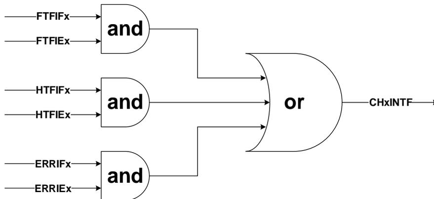
注意：“x”表示通道数（DMA0对应x=0...6；DMA1对应x=0...4）
