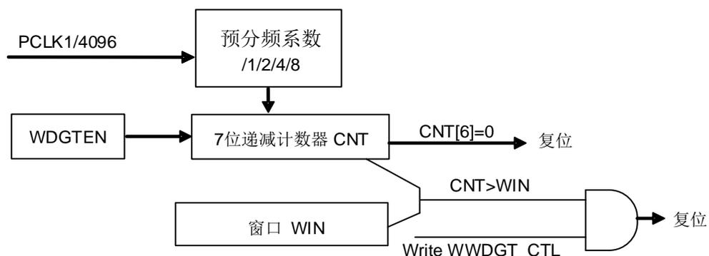
上电复位之后窗口看门狗定时器总是关闭的。软件可以向 WWDGT\_CTL 的 WDG TEN 写 1 开启窗口看门狗定时器。窗口看门狗定时器打开后，计数器始终递减计数，计数器配置的值应该大于 0x3F，也就是说 CNT[6]位应该被置 1。CNT[5:0]决定了两次重载之间的最大间隔时间。计数器的递减速度取决于 APB1 时钟和预分频器（WWDGT\_CFG 寄存器的 PSC[1:0]位）。
