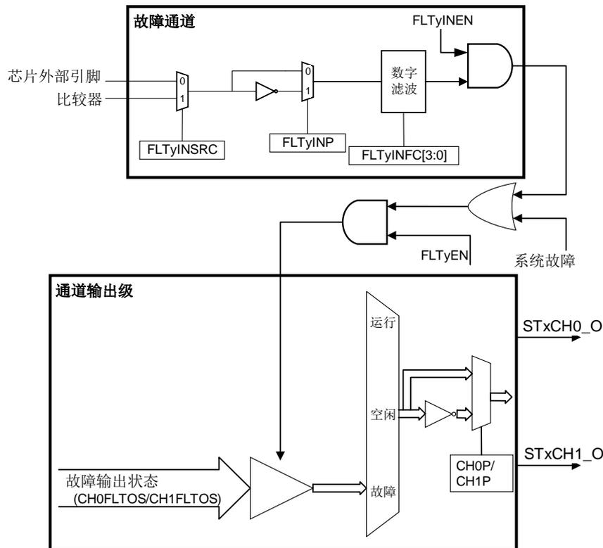
通过 SHRTIMER\_STxFLTCTL 寄存器中的 FLTyEN 位使能故障输入。对 SHRTIMER\_STxFLTCTL 寄存器中的 FLTENPROT 位的一次写入可以保护 FLTyEN 位。当 FLTENPROT 位置 1 时，FLTyEN 位写保护（只读）。
