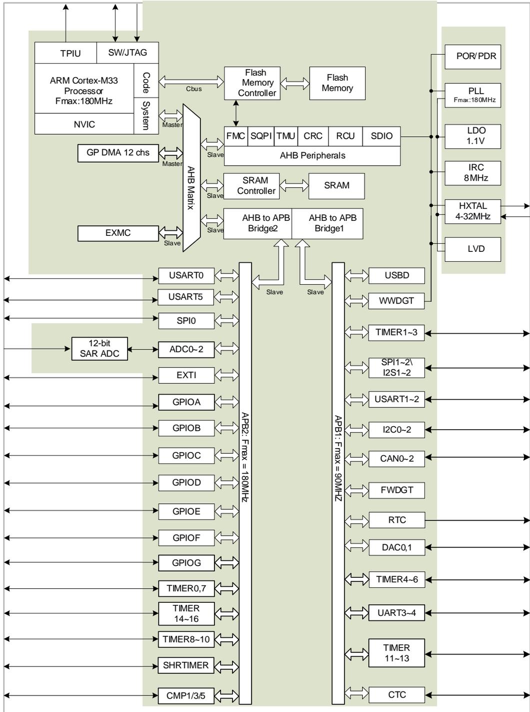
图 1-3. GD32E51x\_CL 系列器件的系统架构示意图
