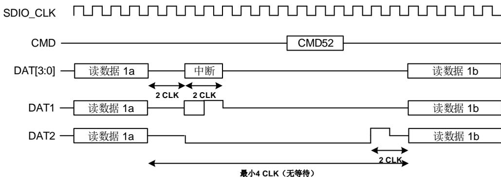
在接收到数据块之前就可以开始读等待：当数据单元使能(设置 SDIO\_DATACTL[0]位)，SD I/O 特定操作使能(设置 SDIO\_DATACTL[11]位)，开始读等待(SDIO\_DATACTL[10] = 0 并且 SDIO\_DATACTL[8] = 1)，数据方向为从卡到 SD I/O 主机 (SDIO\_DATACTL[1] = 1)，DSM 直接从空闲状态到读等待状态。在读等待时，2 个 SDIO\_CLK 时钟周期后，DSM 驱动 SDIO\_DAT[2] 为 0。在这种状态下，当设置了 RWSTOP 位(SDIO\_DATACTL[9])时，DSM 会在等待状态多停留 2 个 SDIO\_CLK 时钟周期，并在一个时钟周期中驱动 SDIO\_DAT[2] 为 1。然后 DSM 再次开始等待直到从卡里接收到数据。在接收数据块时，即使设置了开始读等待，DSM 也不会开始一个读等待间隔，读等待将在收到 CRC 后开始。必须清除 RWSTOP 才能开始新的读等
