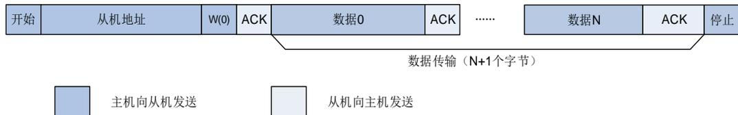
图 21-19. 7 位地址的 I2C 通讯流程（主机接收）
