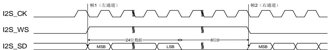
图 22-28. MSB 对齐标准时序图 (DTLEN=01, CHLEN=1, CKPL=1)
