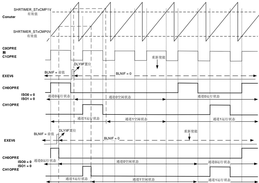
SHRTIMER\_STxINTF 寄存器中的 BLNIF 位指示了发生均衡空闲模式时哪个通道正在输出信号。如 [图 19-34. 均衡空闲模式, ISO0 = 0 和 ISO1 = 0](#), 外部事件 6 (EXEV6) 到来时, 通道 0 输出信号, 通道 1 输出无效, 且 BLNIF 位复位为零。
