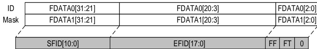
图 26-8. 16-bit 位宽掩码模式过滤器
