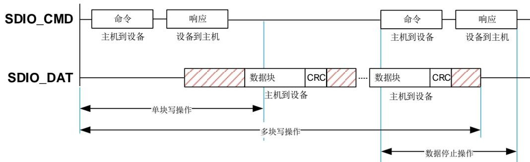
SD 存储卡、SD I/O 卡（包括仅 IO 卡和组合卡）和 CE-ATA 设备直接的数据传输是以数据块的方式完成的。MMC 卡以数据块或数据流方式进行数据传输。[图 24-4. SDIO 数据流读操作](#)和[图 24-5. SDIO 数据流写操作](#)分别是数据流的读和写操作。
