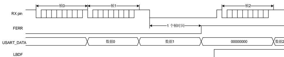
如 [图 20-10. 数据传输过程中检测断开帧](#) 所示, 如果断开帧发生在数据传输过程中, 当前传输帧发生错误, FERR 置位。
