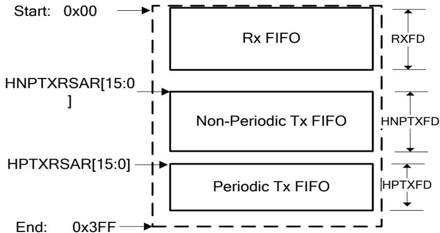
在 DMA 模式下，DMA 负责系统存储区和数据 FIFO 之间的数据包传输。在非 DMA 模式下，程序将包数据写入数据 FIFO 或从数据 FIFO 读取包数据。USBHS 为程序提供了专有寄存器空间来读写数据 FIFO。[图 29-7. 主机模式 FIFO 访问寄存器映射表](#)所描述的是数据 FIFO 所访问的寄存器存储空间，图中的数值是以字节为单位寻址。尽管所有的非周期通道共享相同的 FIFO 以及所有的周期通道共享相同的 FIFO，每个通道都拥有它们的 FIFO 访问寄存器空间。对 USBHS 而言，获知当前压入数据包的通道号是非常重要的，通过寄存器 USBHS\_GRXTATR/USBHS\_GRSTATP 来访问数据包所从属的 Rx FIFO。
