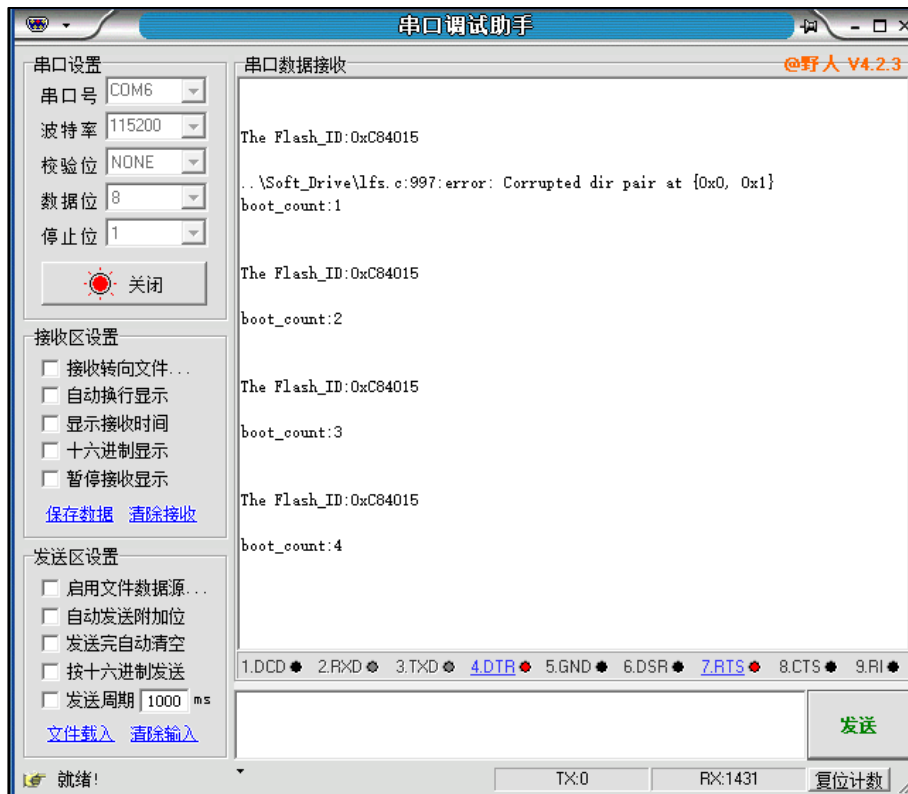
图 0-7. LittleFS 掉电保护功能测试
